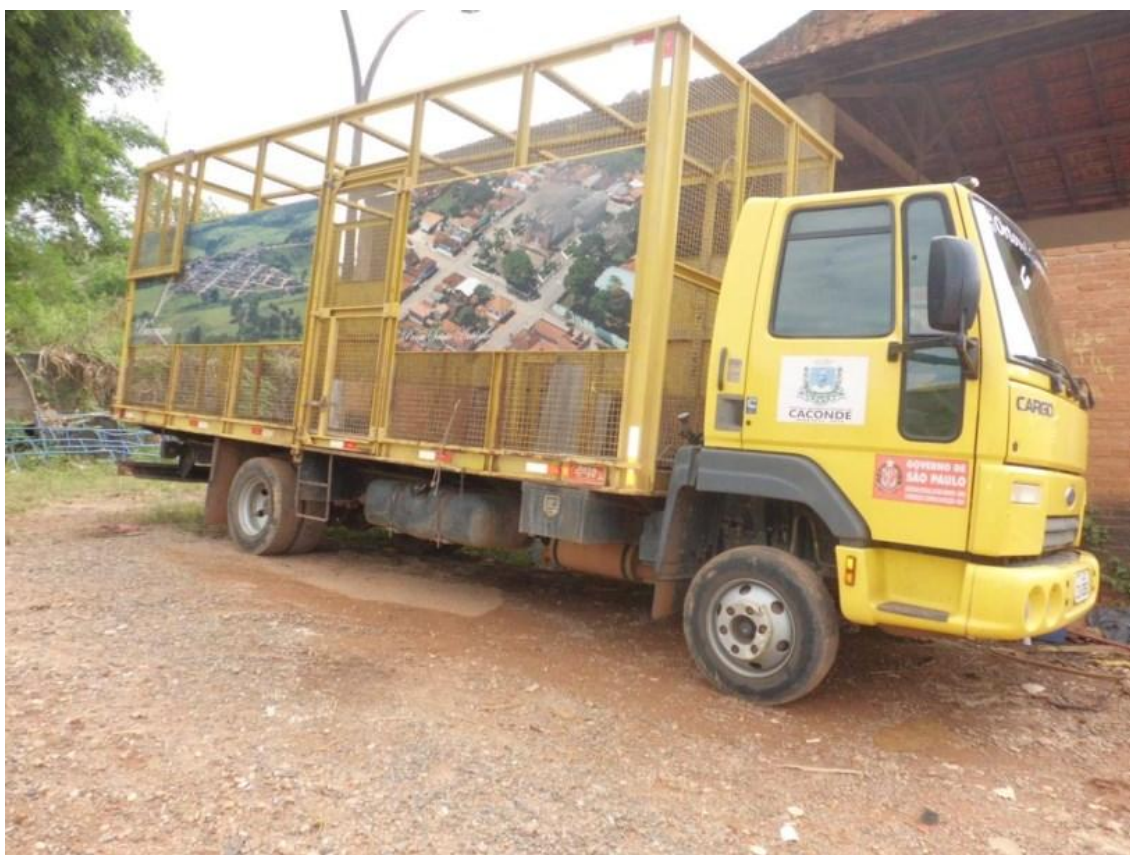
Figura 40: Caminhão gaiola usado na coleta de recicláveis.
